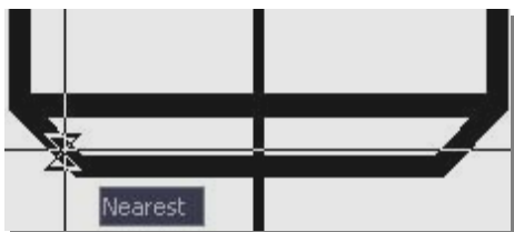
Рис. 5.44. Привязка начальной точки линии резьбы
